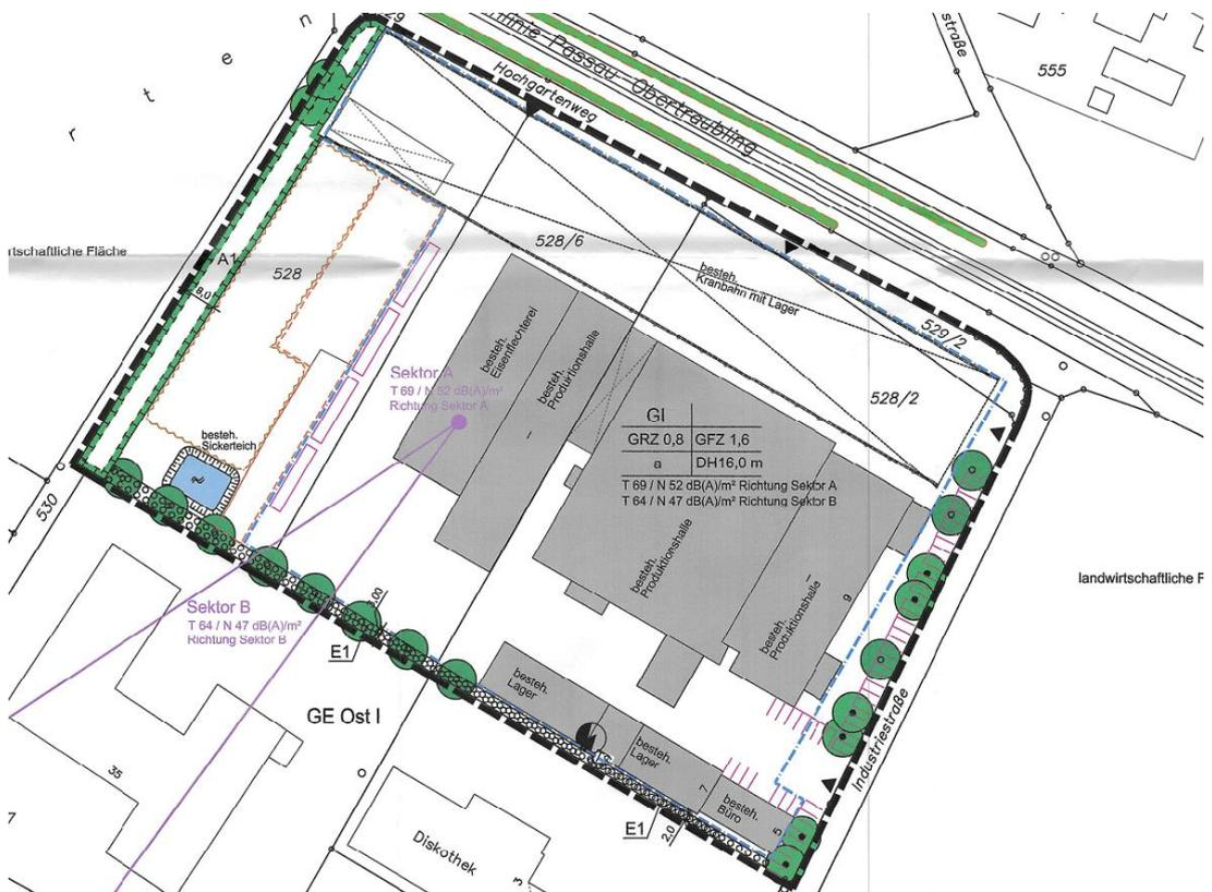
Abbildung B 3. Bebauungsplan "GI Ost II" [26] – Übersicht Planteil mit Richtungssektoren für die Geräuschkontingentierung.
