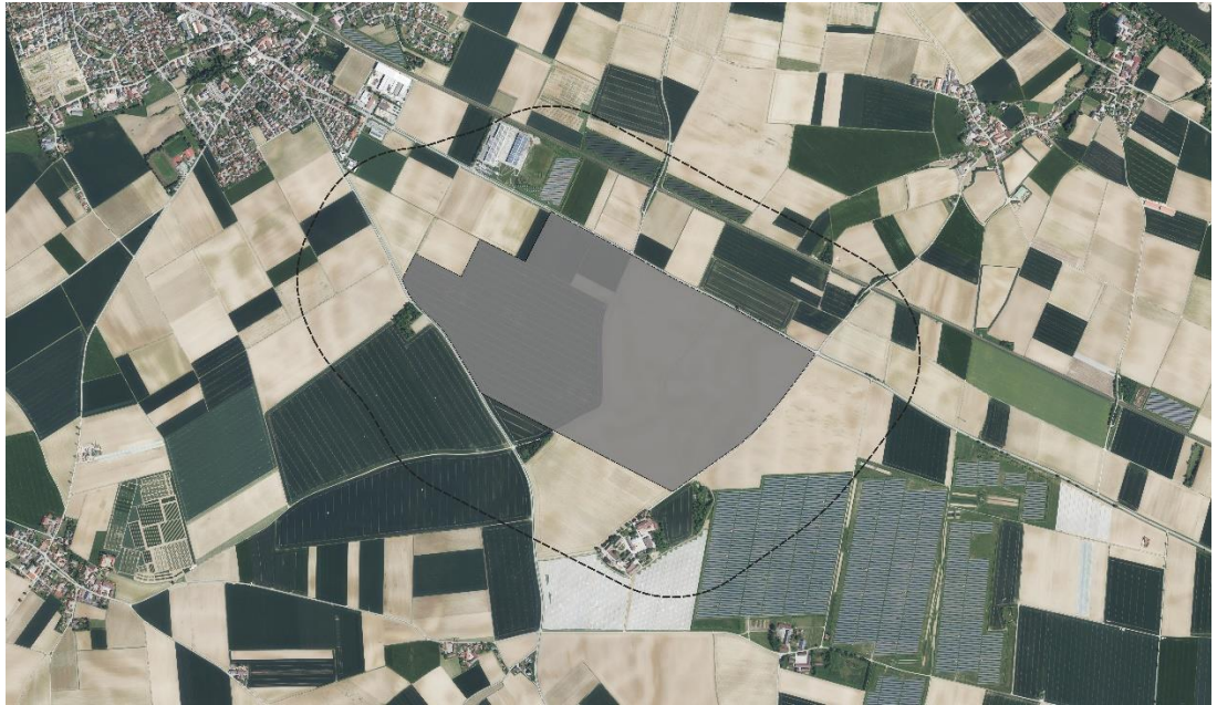
Abbildung 1. Betriebsbereich der geplanten Anlage zur Fertigung von Hochvoltbatterien mit Achtungsabstand 500 m.
