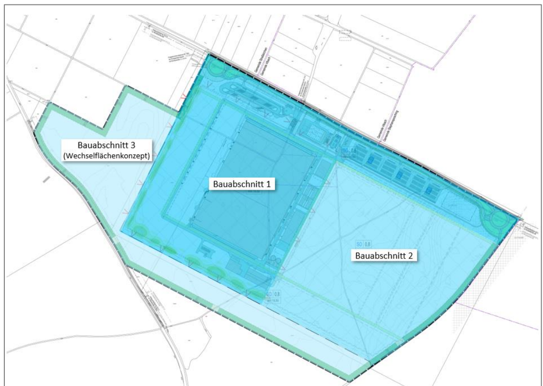
Abbildung 1. Bauabschnitte, Illustration BMW Group.
