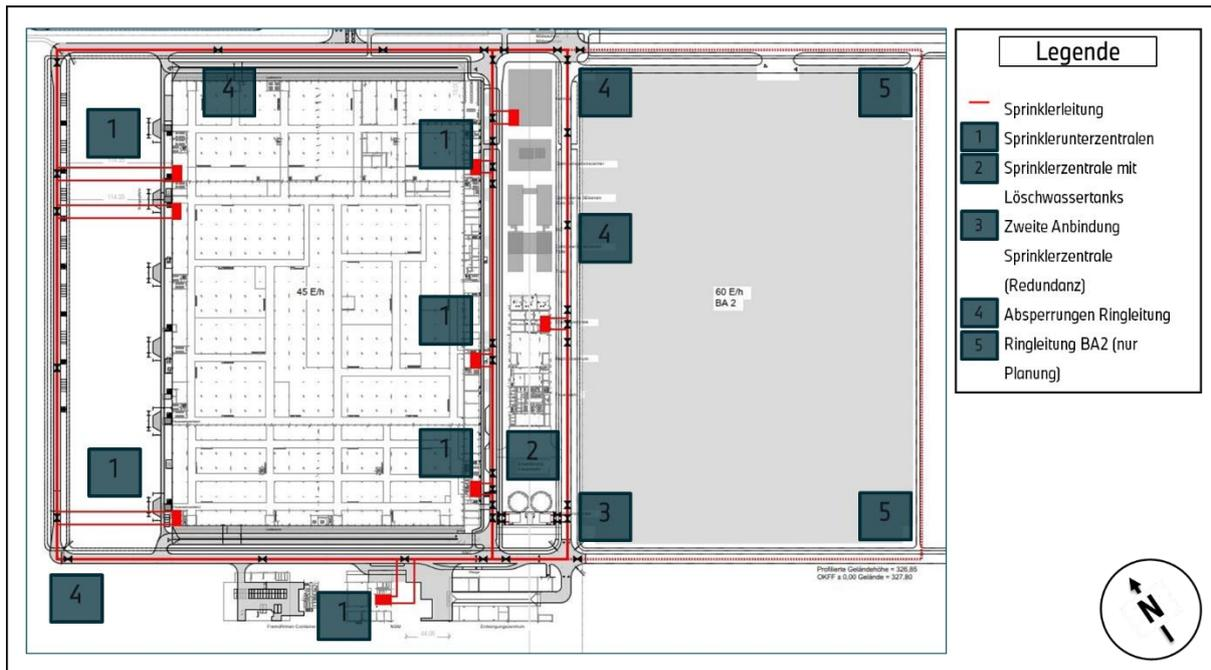
Abbildung 58: Sprinklernetz des Standortes.
