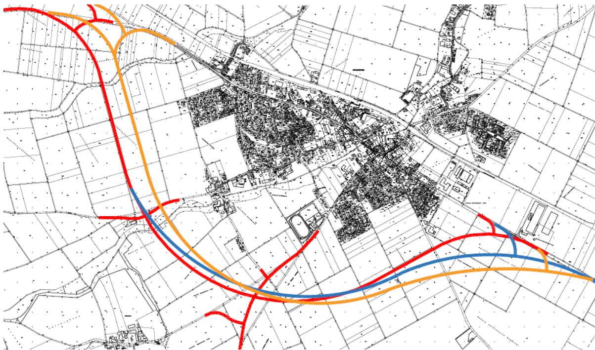
Übersichtsplan (ohne Maßstab) für die Varianten der Ortsumgehung Trassenvariante 1 (orange dargestellt) ca. 4.850 m Trassenvariante 2 (blau dargestellt) ca. 5.400 m Trassenvariante 3 (rot dargestellt) ca. 5.170 m (Variante Staatl. Bauamt Passau)
